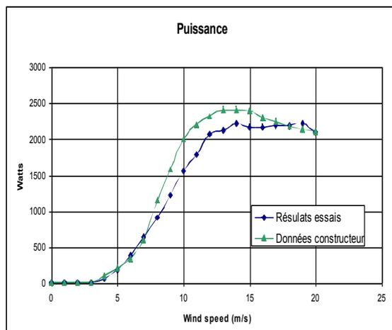
Le présent graphe montre, pour une éolienne testée, la différence entre l'estimation du fabricant ou du vendeur et le résultat in situ. L'écart peut atteindre 30% voire plus.
